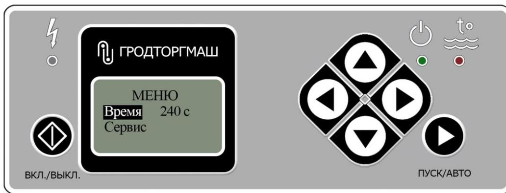
Рисунок 5 – Панель управления с отображенным меню настроек на цифровом дисплее
