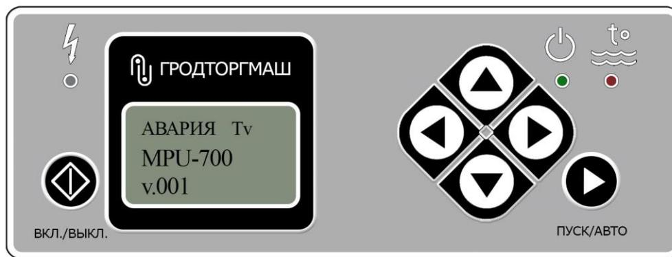
Рисунок 11 – Панель управления с отображенными на цифровом дисплее неисправностями датчика температуры водонагревателя и термopедохранителя.
