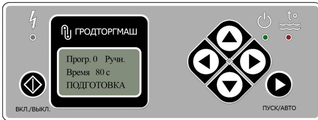
Рисунок 4 – Панель управления с отображенным основным меню на цифровом дисплее
